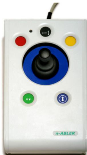
**Le dispositif de pointage spécialement conçu pour faciliter l'usage de l'ordinateur aux personnes en situation de handicap moteur.**
